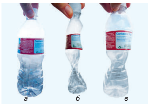
Зураг 1.1.13. Саван дахь агаарын жижиг хэсгийн даралтаас хамаарч савны хэлбэр өөрчлөгдөж байна.
