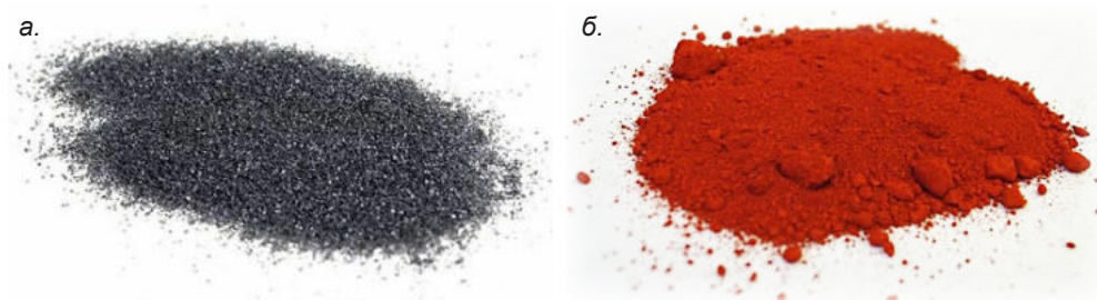
Зураг 3.3.3. а. Төмөр үртэс (төмөр) б. Төмрийн зэв (төмрийн оксид)
