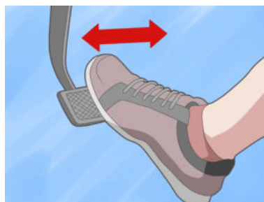
Машины тормозны шингэний урсамтгай, шахагддаггүй чанарыг ашиглан машиныг зогсоодог.
