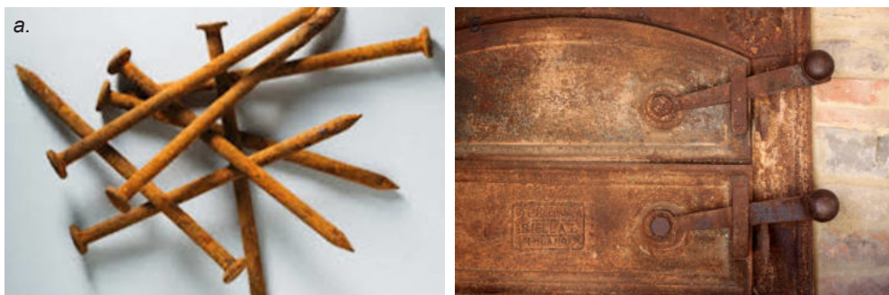
Зураг 3.3.4. Зэвэрсэн эдлэл: а. Зэвэрсэн хадаас, б. Зэвэрсэн ширэм
