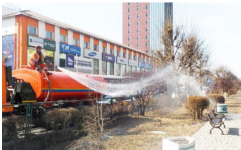
Зураг 8.23. Цэвэршүүлсэн “саарал” усыг зүлэг мод услахад ашиглаж байгаа нь
