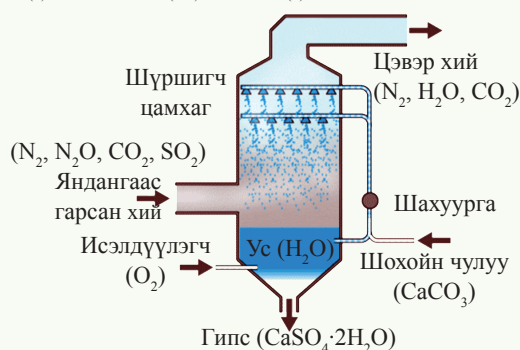
Зураг 3.2.6. Үйлдвэрийн яндангийн утаан дах үүсэх хүхэр (IV)-ийн оксидыг шохойн чулуугаар саармагжуулах бүдүүвч
