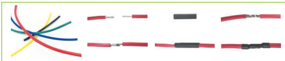
2.3.3.28 дугаар зураг. а. Халуунд агшдаг гуураас б. халуунд агшдаг гуурсаар утасны холбоосыг бүрэх дараалал
