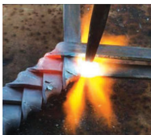
2.4.7 дугаар зураг. а-цувимал металлыг халуун аргаар сүлжих байдал. б-сүлжмэлийн хэлбэрүүд
