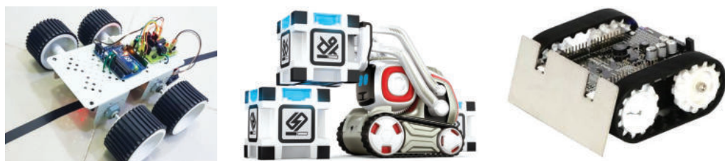
2.3.81 дүгээр зураг. А.Зураас мэдрэгч робот, Б. Шоо цуглуулагч, В. Сумо робот
