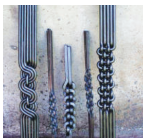
2.4.7 дугаар зураг. а-цувимал металлыг халуун аргаар сүлжих байдал. б-сүлжмэлийн хэлбэрүүд
